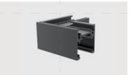
L-形 (向下) 型号: L90-MS20 材质: AL6063-T5 尺寸: L50×W50×H27.3mm 应用款型: TLS-MS2X0
