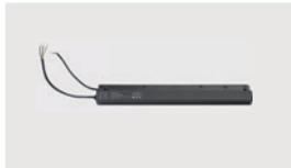
磁吸电源 型号: MT20-HDRV200H48S-M 尺寸: L305×W22.5×H46mm 输入电压: 220-240VAC 输出: DC48V 功率: 200W 应用款型: 所有直线轨道
