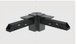
L-形可调节 (向下) 型号: L90-MH20(A) 材质: AL6063-T5 尺寸: L120×W27.2×H52mm 应用款型: TLS-MH2X0
