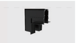
L-形 (向内) 型号: L90N-MR20(C) 材质: AL6063-T5 尺寸: L80×W80×H64mm 应用款型: TLS-MR2X0(C)
