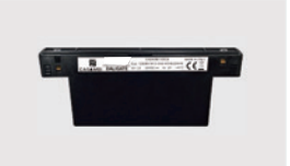
CASAMBI控制器 型号: 1200EN1812-CAS-W0-BLDAV48 尺寸: L142.6×W18×H58.1mm 输入电压: 48VDC 输出信号: DALI DALI最大输出电流: 180mA 控制设备数量: ≤64
