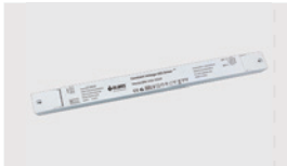
电源 型号: BN-V48-250P 尺寸: L400×W40×H22mm 输入电压: 220-240VAC 输出: DC48V 功率: 250W 应用款型: 所有轨道
