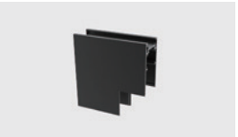
L-形 (向内) 型号: L90N-MH20 材质: AL6063-T5 尺寸: L80×W80×H27.2mm 应用款型: TLS-MH2X0
